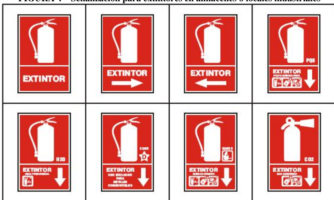
FIGURA 4 – Señalización para extintores en almacenes o locales industriales
