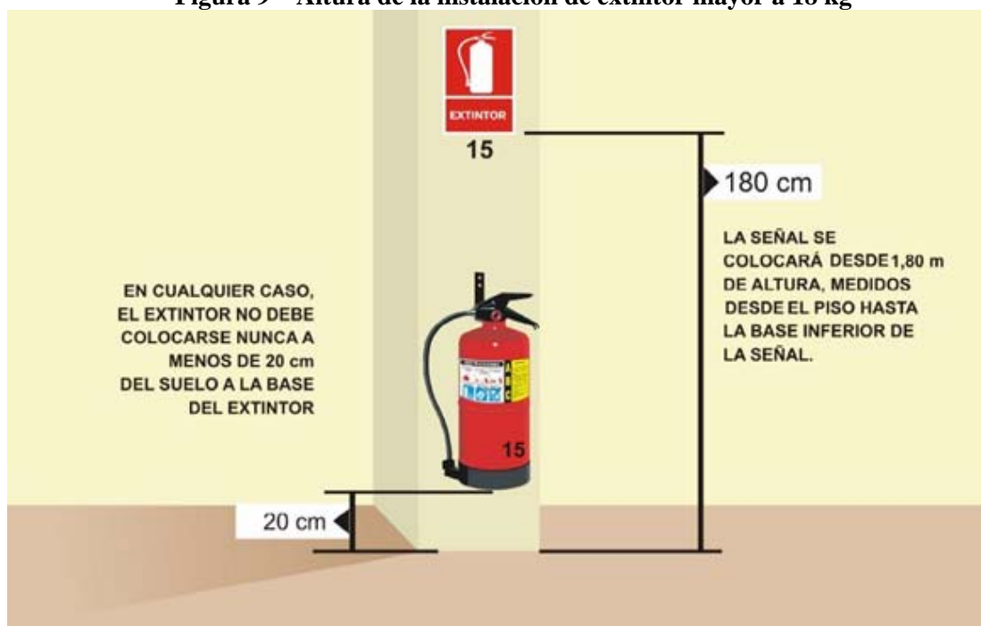
Figura 9 – Altura de la instalación de extintor mayor a 18 kg
