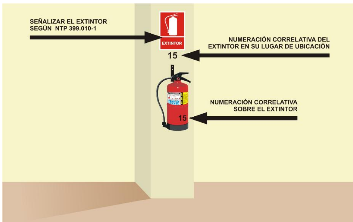
FIGURA 3 – Señalización del extintor
